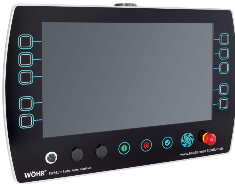
Mechanisch gebogener Aluminium-Rahmen, kundenspezifische Glasfront, kapazitiver Touchscreen, taktile Glastasten und kapazitive Einzeltasten, Notastaster, USB-Anschlüsse sowie Decken- oder Bodenmontage
