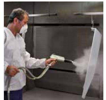
Der Pulverlack wird elektrostatisch appliziert
