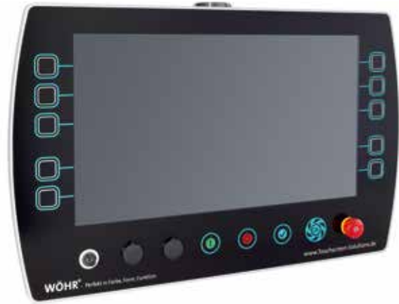
▲ Eingabesystem von WÖHR. Bestehend aus einem mechanisch bearbeitetem Aluminiumgehäuse mit kundenspezifischer Glasfront, kapazitivem Touchscreen, taktilem und beleuchtbar Glasstasten und kapazitiven Einzelstasten, Notastaster und USB-Anschlüssen. Das Eingabesystem eignet sich zur hängenden oder stehenden Montage
