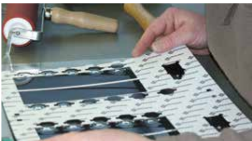
Aufbringen eines Klebelaminates
