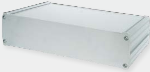
Série ALU-ECOPAC Standard Hauteur H = 30, 40, 50, 60, 70, 80 ou 100 mm pour circuit imprimé (Lo x La) 160 x 100 mm ou 160 x 200 mm
